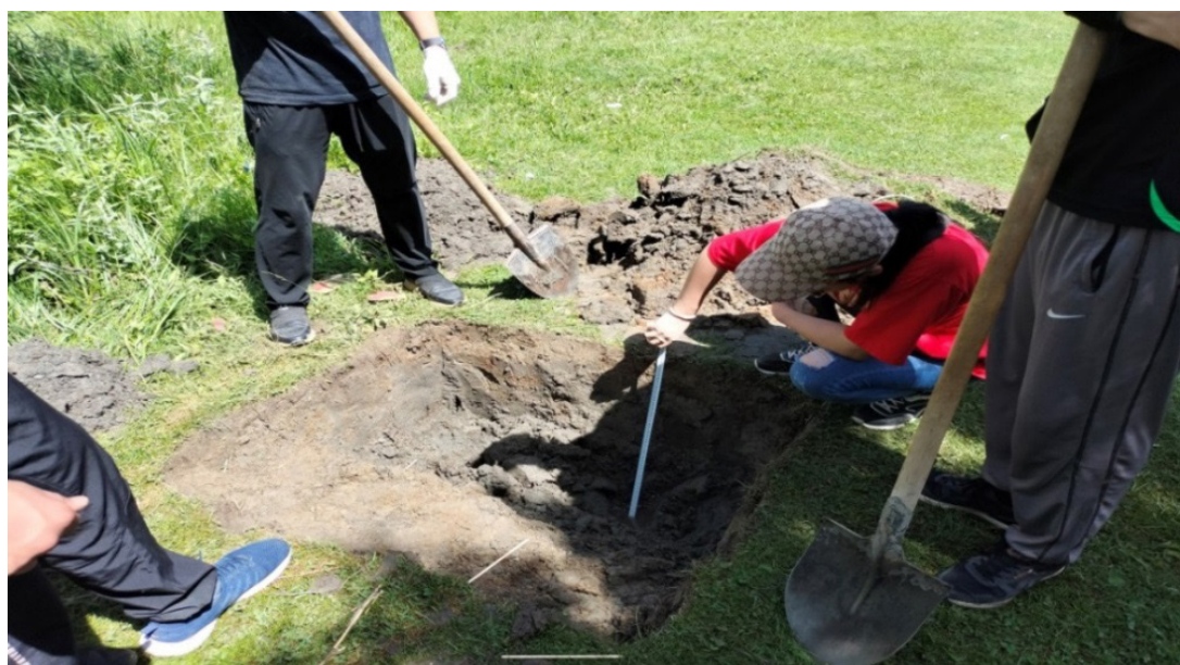
6-сурет – Топырақ қабаттарының қимасын жасау
