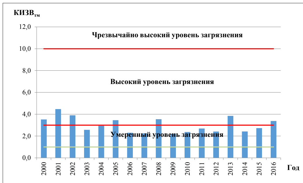
Рисунок 3 – Динамика изменений КИЗВ т.м. в створе р. Ертис – с. Предгорное, 1 км ниже впадения р. Красноярка за период 2000-2016 гг.
