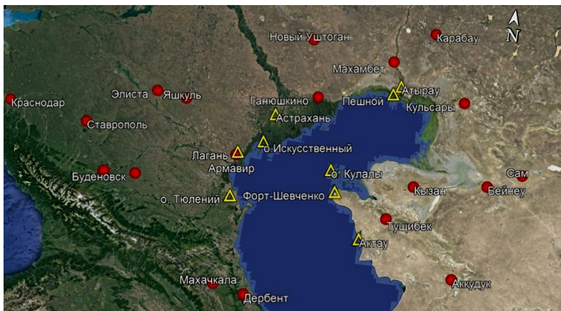
Рисунок 1 – Расположение гидрометеорологических станций и постов (желтые треугольники – наблюдение за толщиной льда и температурой воздуха, красные кружки – только наблюдения за температурой воздуха)
