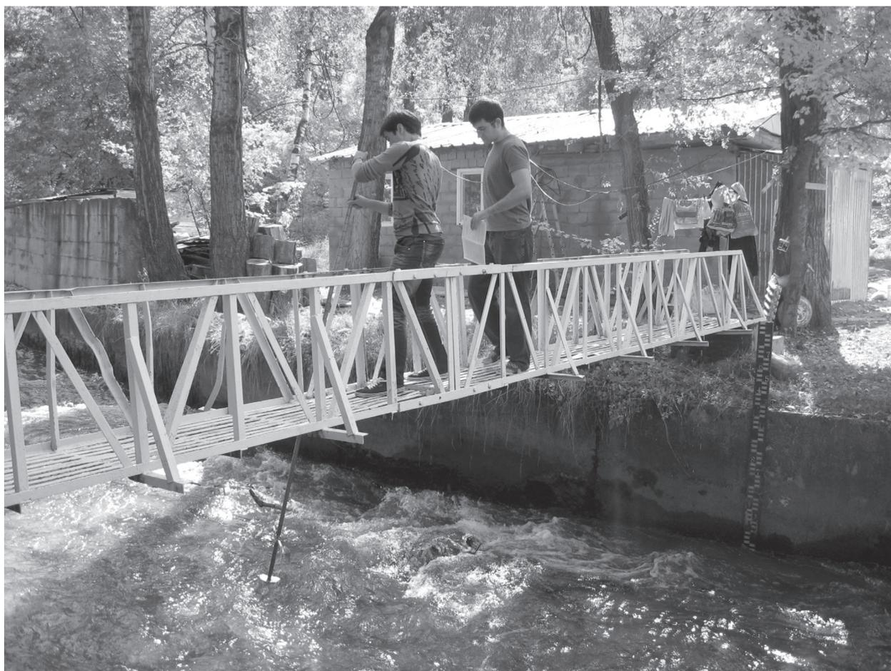
**Рисунок 2** – Измерение расхода воды при исследовании руслового водного баланса р. Киши Алматы («Дамба», 2013 г.)
