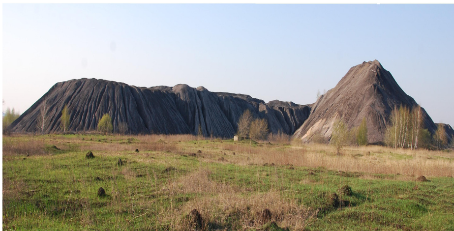
Рисунок 2 – Терриконы складирования надугольных вскрышных и «пустых» пород на одном из месторождений Мосбасса, не зарастающие вследствие токсичности сульфидоносных толщ, изъеденные сетью водороев до состояния bad lands (фото А. Шараповой)
