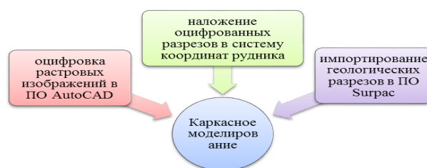
Рисунок 3 – Этапы создания каркасной модели месторождения
