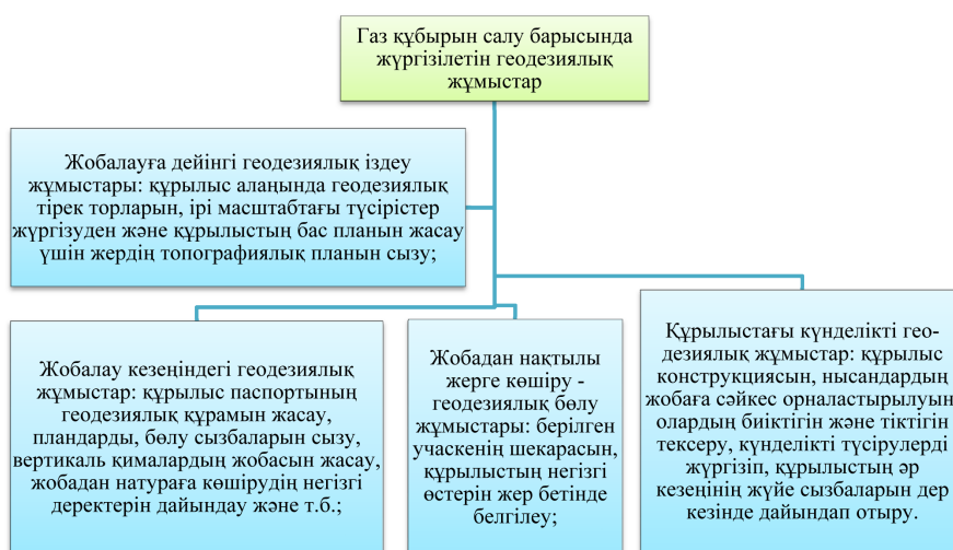
2-сурет – Газ құбырын салу барысында жүргізілген геодезиялық жұмыстар жиынтығы
