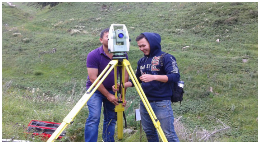
Рисунок 3 – Установка тахеометра на запроектированной точке на штатив
