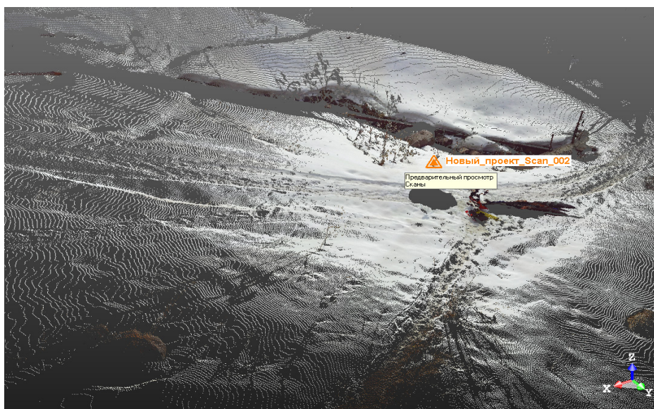
Рисунок – Фрагмент съемки наземного лазерного сканирования лавиноопасной зоны в Алматы (13.04.15 г.)
