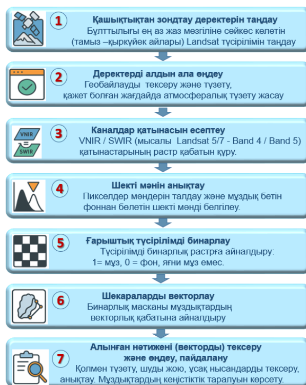
3-сурет – Мұздықтарды дешифрлеуде жартылай автоматты каналдар қатынасы әдісін (Band Ratio Method) қолдану кезеңдері
