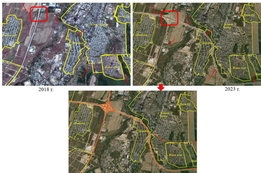
Рисунок 7 – Использование космических снимков Sentinel-2 для актуализации транспортной сети (БАКАД – Новая Большая алматинская кольцевая автомобильная дорога)
